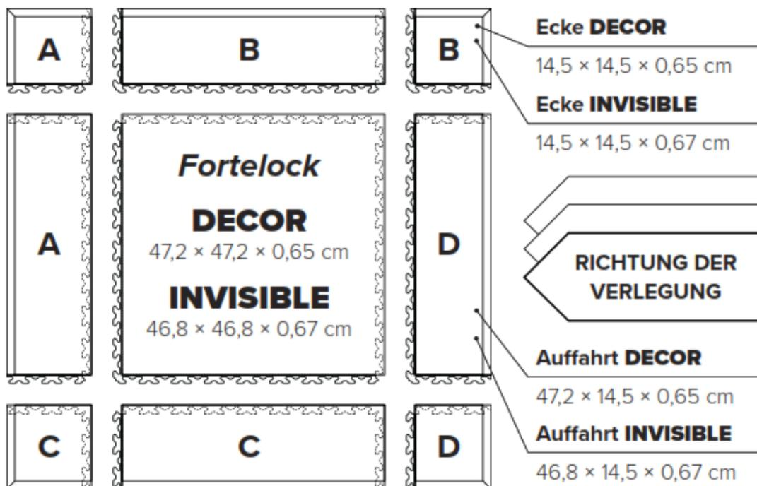
Die Auffahrten und Ecken für die PVC-Fliesen Fortelock, Reihe Light und Industry erfüllen die technischen Parameter der Fliesen Fortelock Industry. Bei den Reihen DECOR, SOLID und
